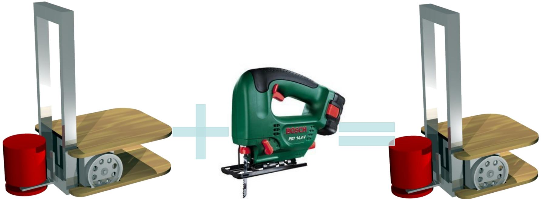
Verkürzung des Roboterchassis um 5cm um die Beweglichkeit des Roboters zu verbessern
