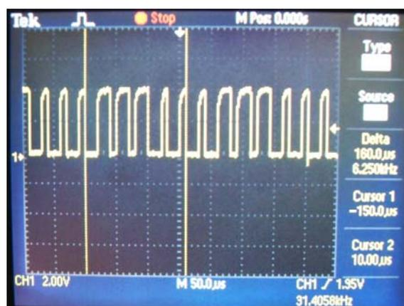
Aus System A kann man bei periodischen Threads bis zu  $3\mu\text{s}$  Periodendauer herab gehen (danach bleibt das System stehen, der Thread läuft weiter).
